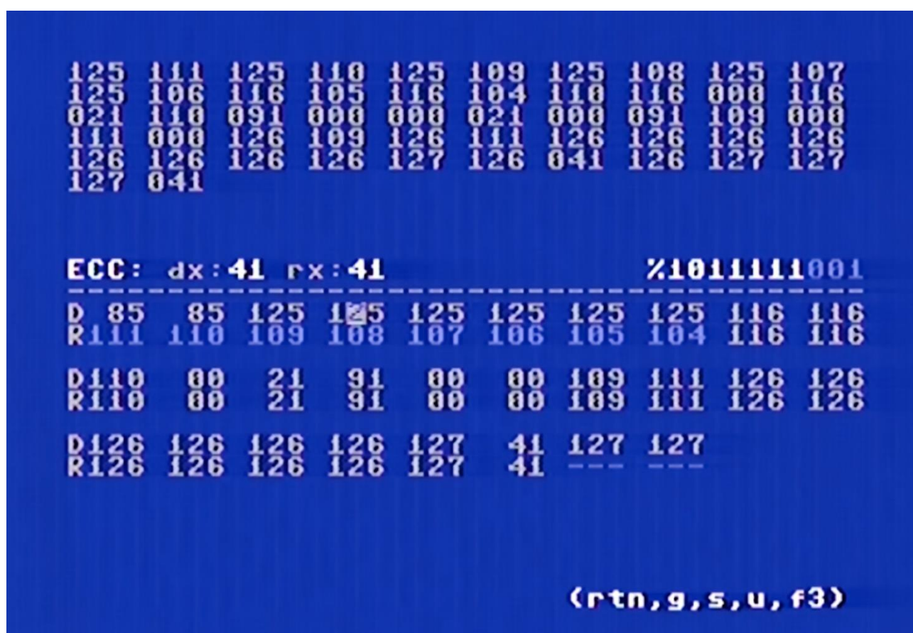
Fig.3 Modtaget DSC-besked. Øverst de modtagne bit (7 databit + 3 paritetsbit) på decimal form, og nederst korrigeret for FEC *4 -forskydning samt beregnet ECC *5 .
